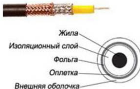
Рисунок 11 – Конструкция коаксиального кабеля
