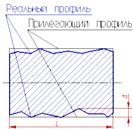
Рисунок 14 - Отклонение профиля продольного сечения
